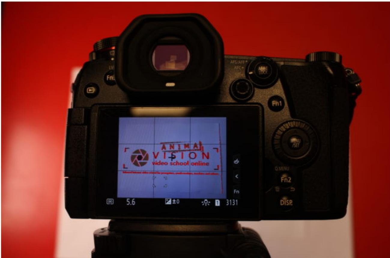
*Kameraanzeige mit Peaking-Funktion (rote Punkte)*
